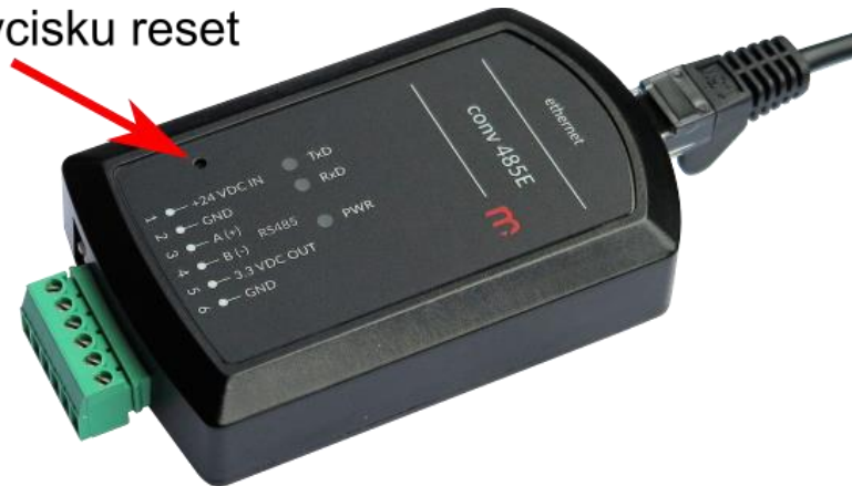
Rysunek 3.5 Przywracanie ustawień fabrycznych
